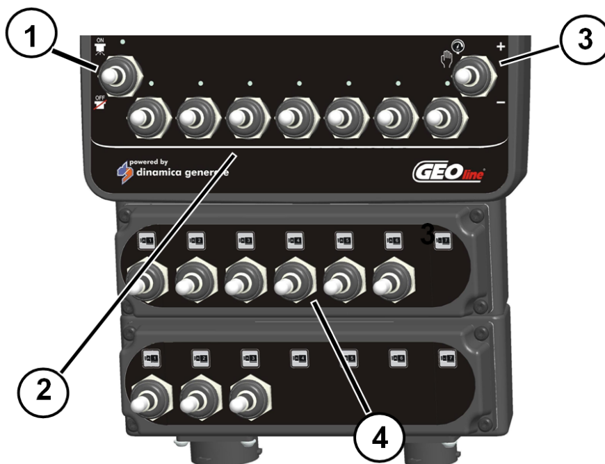
Рис. 7 – Раскладка тумблеров, версия с управлением гидравликой
