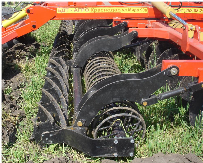
Рис. 4. Двухрядный прикатывающий каток.
