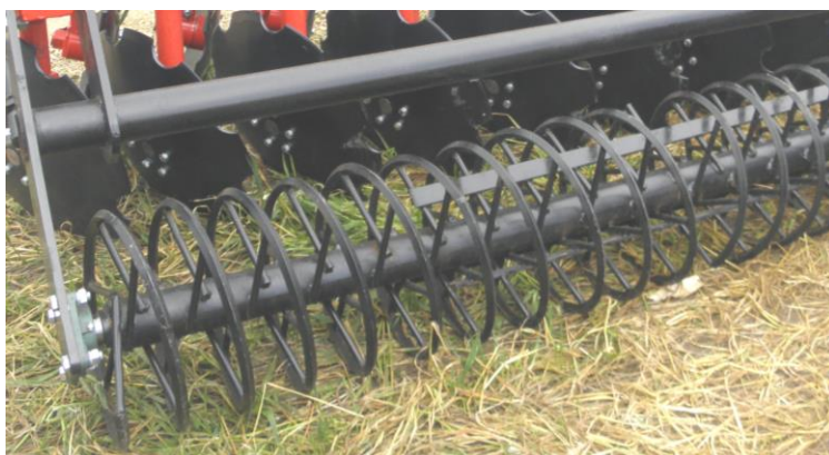
Рис. 6. Спиральный прикатывающий каток.
