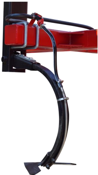
Вывод питателя под лапу культиватора
