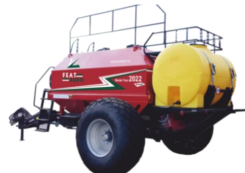
Бункер с системой внесения жидких удобрений
