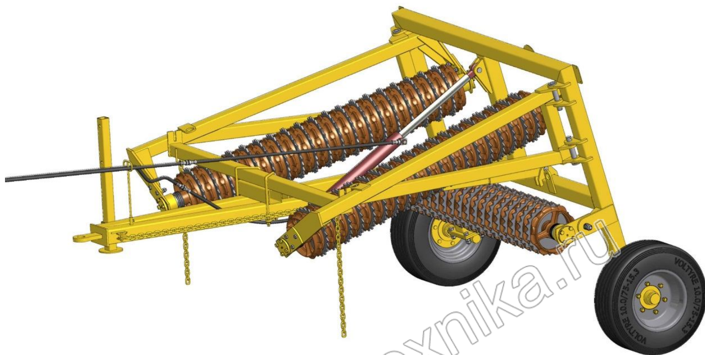
Рисунок 3 – Транспортное положение катка ККЗ-6
