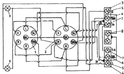
**Рис. 2 Схема электрической системы прицепа**
