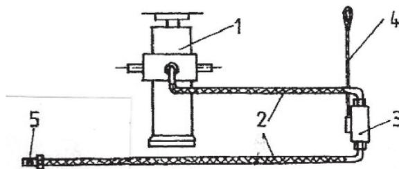
**Рис. 1** Схема гидравлической системы механизма опрокидывания грузового кузова
