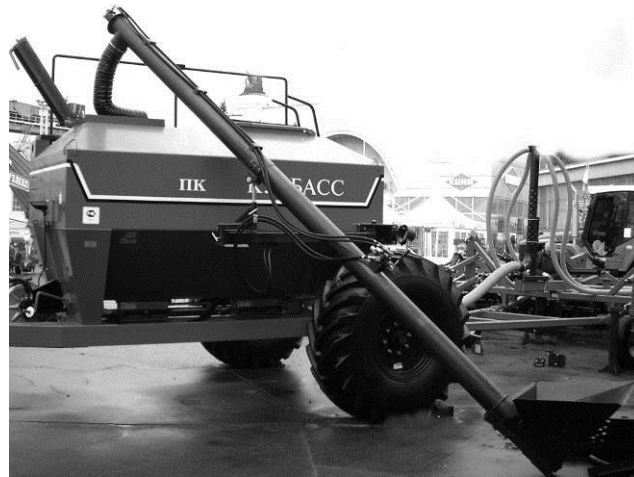
Рис. 6.5.3. Шнек в положении «загрузка»
