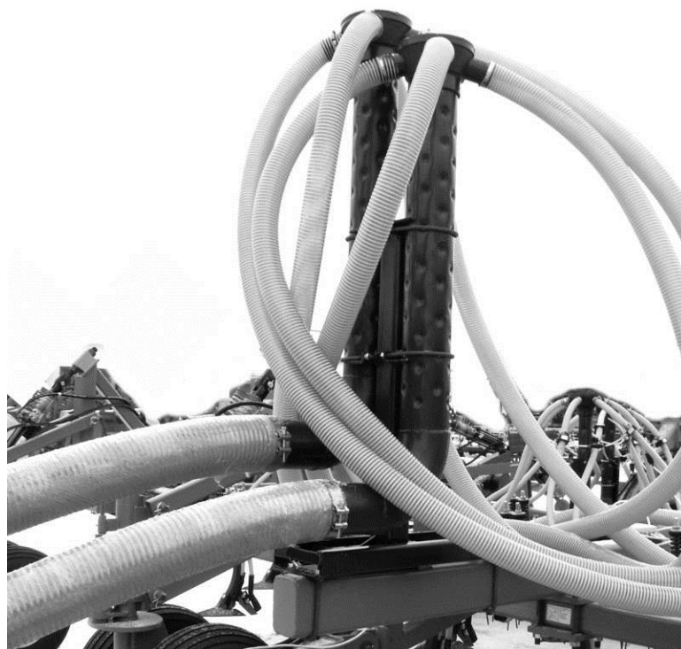
Рис. 4.9.2.1. Сборка первичного коллектора для ПК раздельным высевом семян и удобрений.
