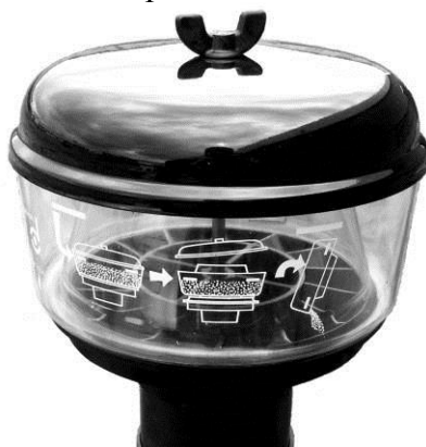
Рис. 6.6.10. Камера предочистки воздуха
