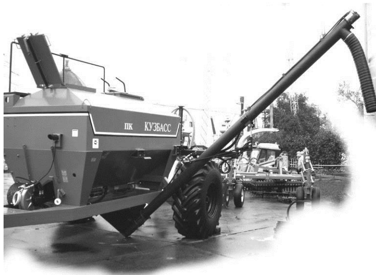
Рис. 6.5.4. Шнек в положении «разгрузка»
