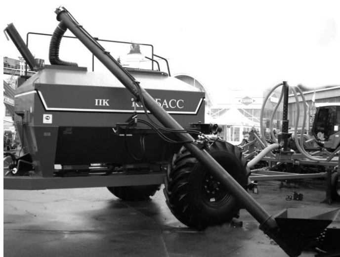
Рис. 6.5.3. Шнек в положении «загрузка»
