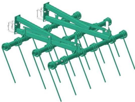
Рисунок 9 – ПБП - трёхрядная пружинная борона
