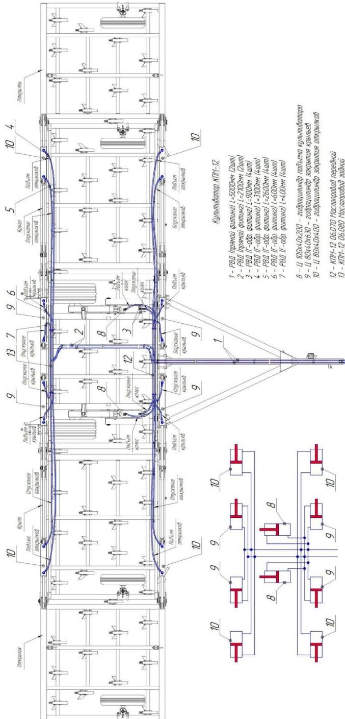
Рисунок 7 – Схема гидросистемы культиватора КТМ-12
