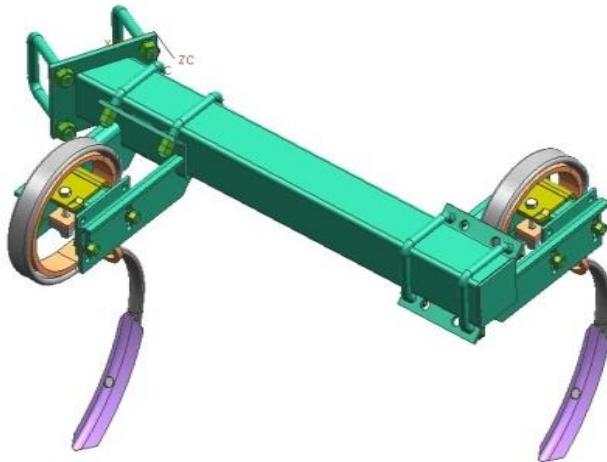
Рисунок 5 – Следорыхлитель
