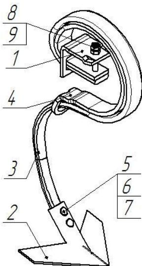
Рисунок 15 – КШЗ 00.050 Стойка с лапой
