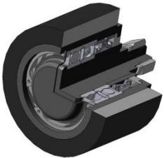
Рисунок 17 – ККУ-1 02.300-01 Ролик в сборе
