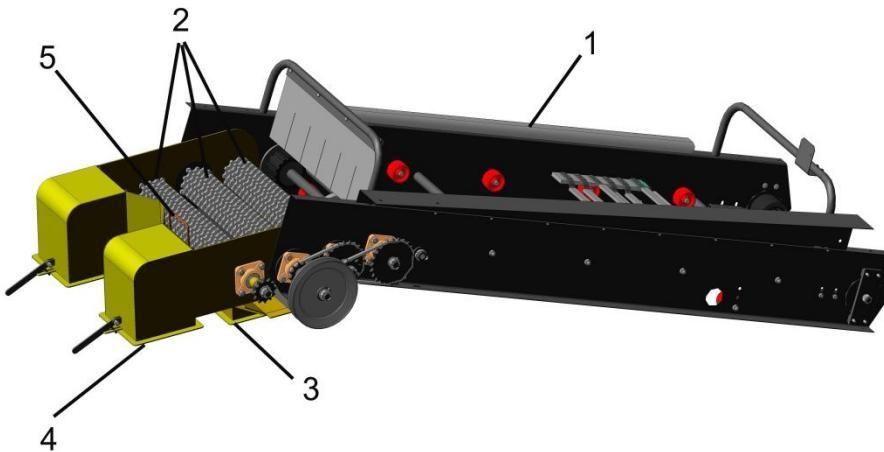
Рисунок 10 – Приспособление для загрузки картофеля в мешки
