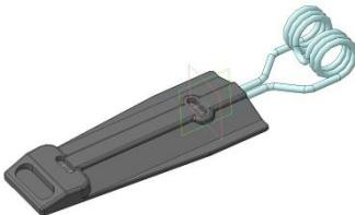
Рисунок 18 – ККУ-1 02.500 Разравниватель
