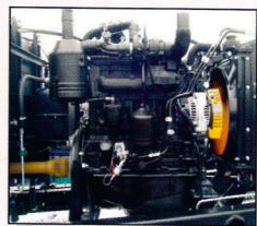
Дизельный двигатель D-245.5 мощностью 65 кВт
