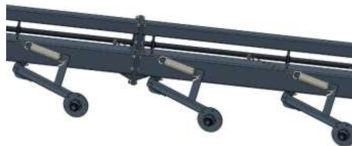
Независимое крепление рабочих колес
