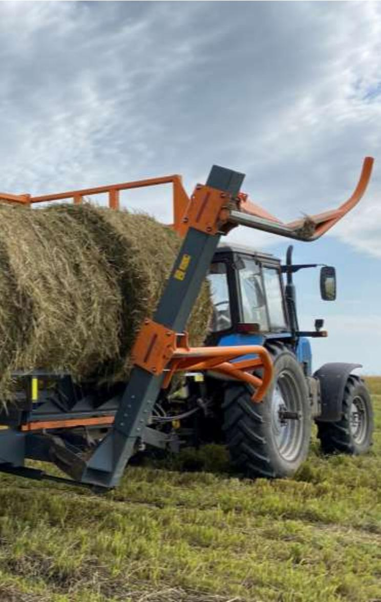
Подборщик-транспортировщик рулонаов предназначен для подбора в поле рулонаов из травянистых масс, их транспортировки к месту хранения и разгрузки.
