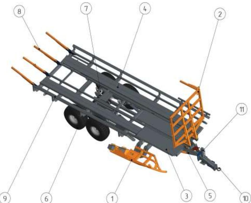
1. Рукав загрузки (с телескопическим раскладыванием на моделях TRB20 и TRB20L)
