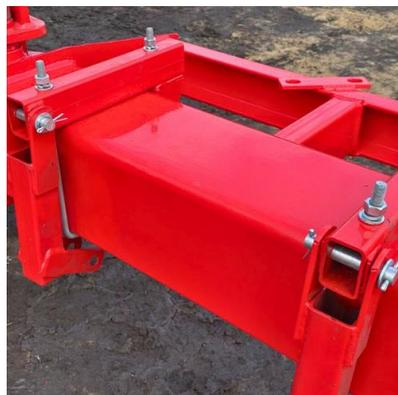
Крылья и задняя часть - металл - 200x200x8
