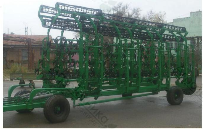
Культиватор, предназначенный для предпосевной обработки почвы, обработки паров. Культиватор может работать во всех почвенно-климатических зонах России при влажности почвы 8-28% и твердости 0,4-1,6 МПа (4-16 кГс/см<sup>2</sup>) в горизонтах от 0 до 15 см на полях с ровным и волнистым до 8° рельефом местности, кроме зон, подверженных ветровой эрозии. Не допускается наличие в почве и на поверхности поля камней размером свыше 20 см, а также скопления куч соломы, наличие шпагата, проволоки.
