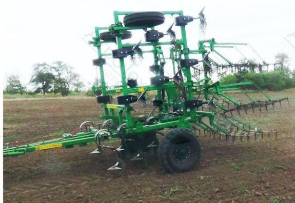
Для предпосевной обработки почвы и уходу за парами. Культиваторы комплектуются приспособлениями для навески зубовых борон, комплектами вычесывающих пружинных борон и комплектами прикатывающих планчатых катков для выравнивания почвы. Пригодны к эксплуатации во всех почвенно-климатических зонах России при влажности почвы 8-28% и твердости 0,4-1,6МПа в горизонтах от 0 до 15 см на полях с ровным волнистым до 8 градусов рельефом местности, кроме зон, поврежденных ветровой эрозии.
