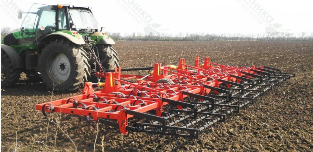
Культиваторы серии КШУ предназначены для предпосевной обработки всех типов почв по фонам культивации и вспашки, с заделкой развалых борозд. Культиватор КШУ качественно выполняет за один проход уничтожение сорняков, рыхление (до 15см), выравнивание, мульчирование и прикатывание почвы (регулируемое уплотнение верхнего слоя почвы) с созданием в посевном слое уплотненного ложа для семян, обеспечивает ресурсосберегающую комплексную обработку почвы.
