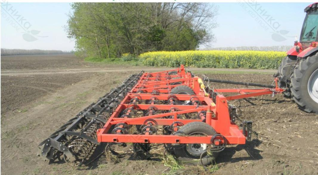
Культиваторы серии КСО предназначены для предпосевной обработки всех типов почв по фонам культивации и вспашки, с заделкой развалых борозд. Культиватор КСО качественно выполняет за один проход уничтожение сорняков, поверхностное (до 10 см) рыхление, выравнивание, мульчирование и прикатывание почвы (регулируемое уплотнение верхнего слоя почвы) с созданием в посевном слое уплотненного ложа для семян, обеспечивает ресурсосберегающую комплексную обработку почвы.
