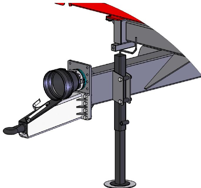
Рис. 2. Опора разбрасывателя N272/1, 272/2
