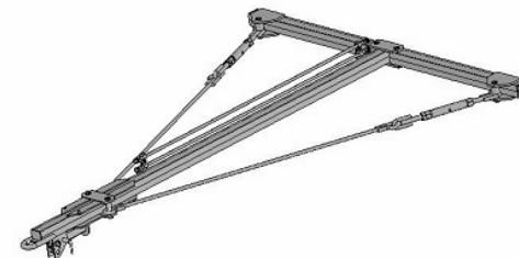
Рисунок 51- Сцепка СКП 02.00.000В для составления посевного комплекса из 2-х сеялок
