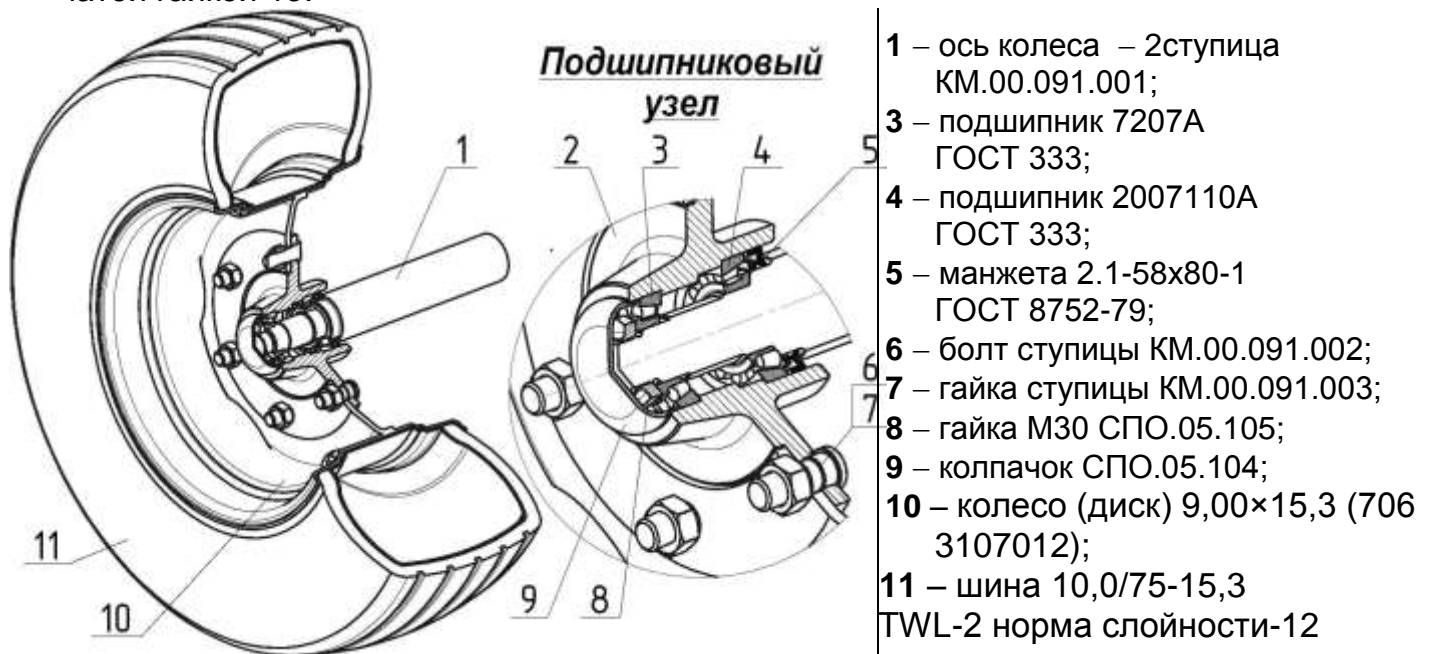
Рисунок 7 – Колесо в сборе КПП.80.00.000
