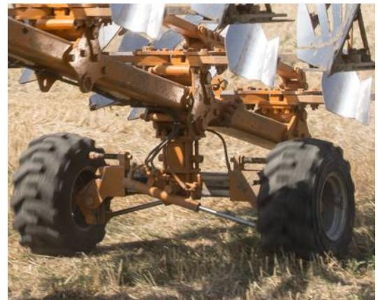
Перевод плуга из рабочего положения в транспортное совершается с помощью гидропривода. На прицепном устройстве имеется особая поворотная головка, благодаря которой на дороге плуг ведет себя как обычный прицеп.
