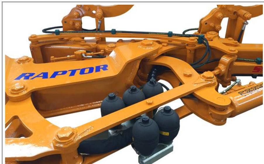
То, что важнейшая задача защиты всей системы выполняется аккумуляторной батареей с непрерывным подзарядом, а не одним аккумулятором, является дополнительным преимуществом данного плуга с точки зрения его надежности.
