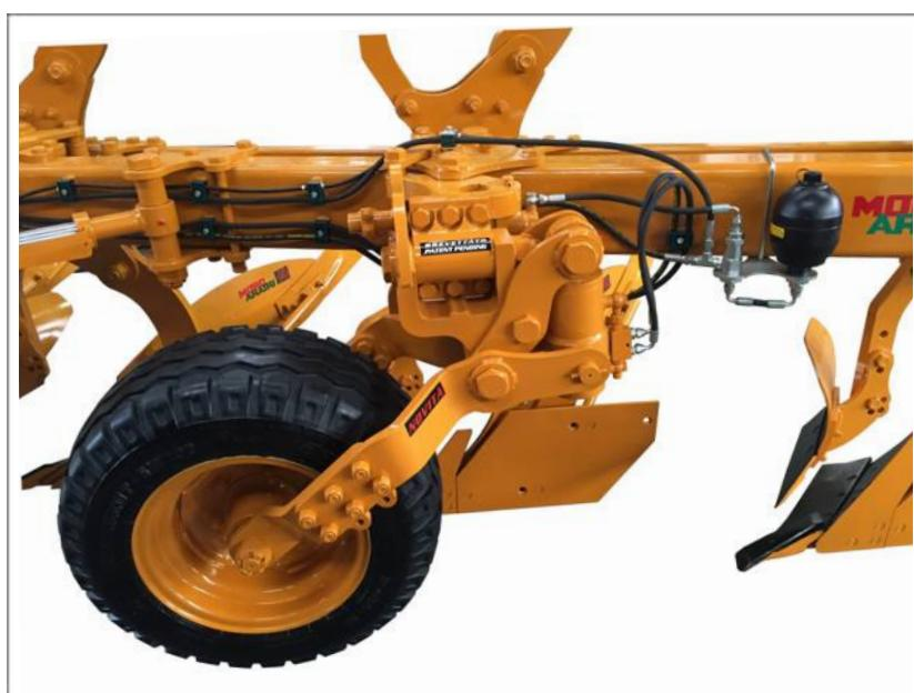
Колесо может устанавливаться в 2 различных положениях:
