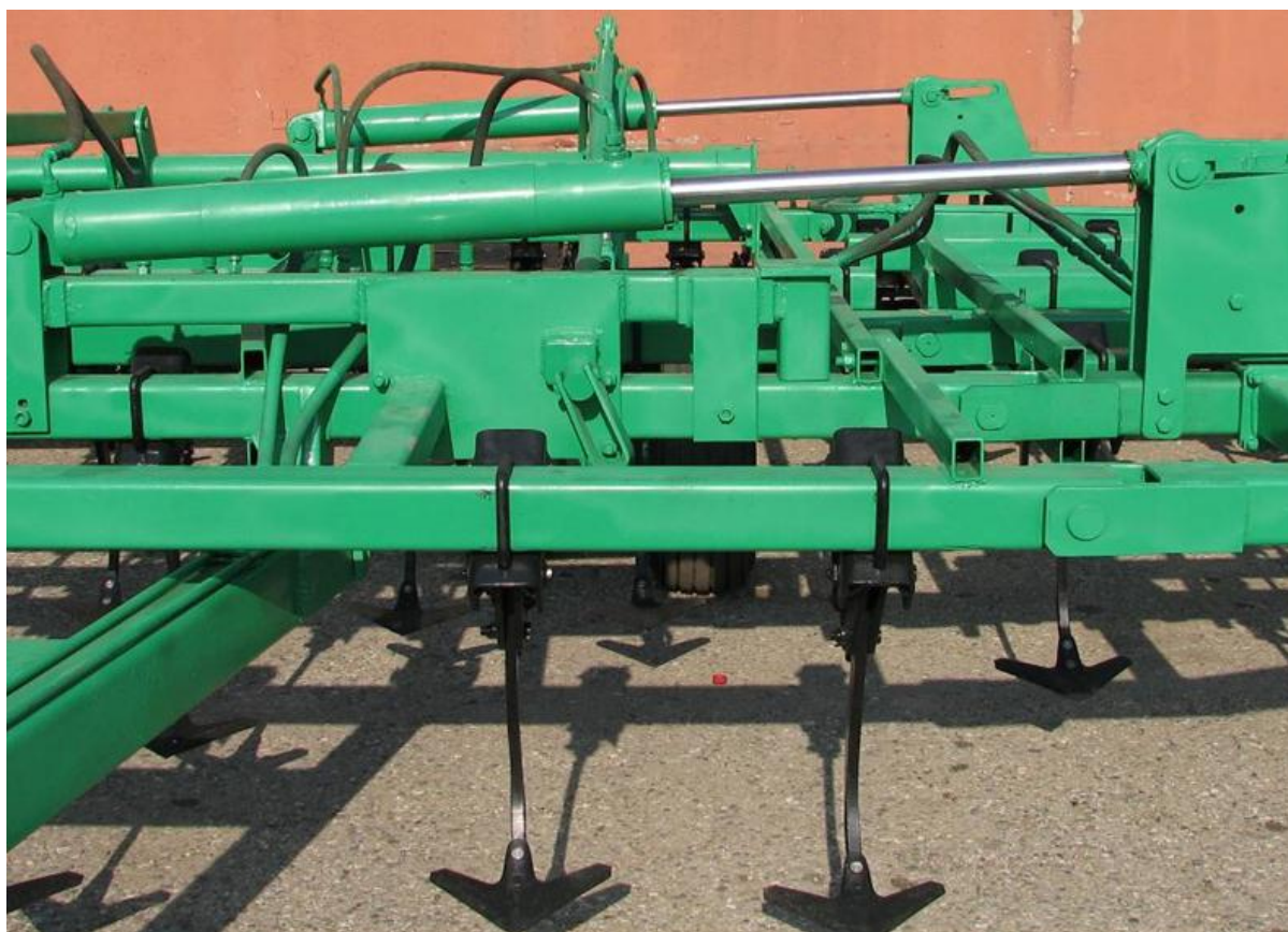
КП-10,0А Установка ГЦ.80.40x630.11 рамы и крыла культиватор КП-12,0А Установка ГЦ.100.50x630.11 рамы и крыла культиватор
