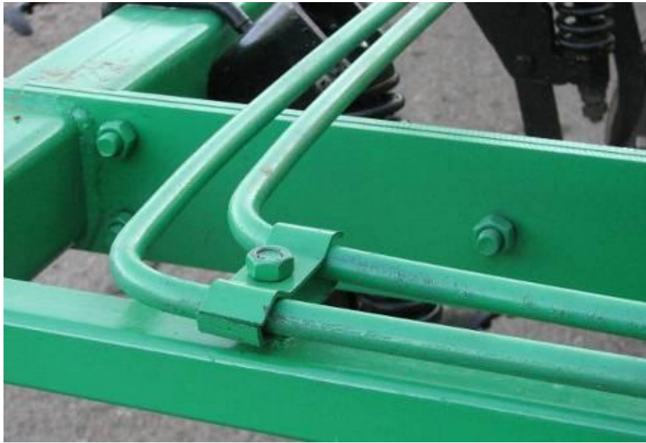
Крепеж трубок гидравлики.
