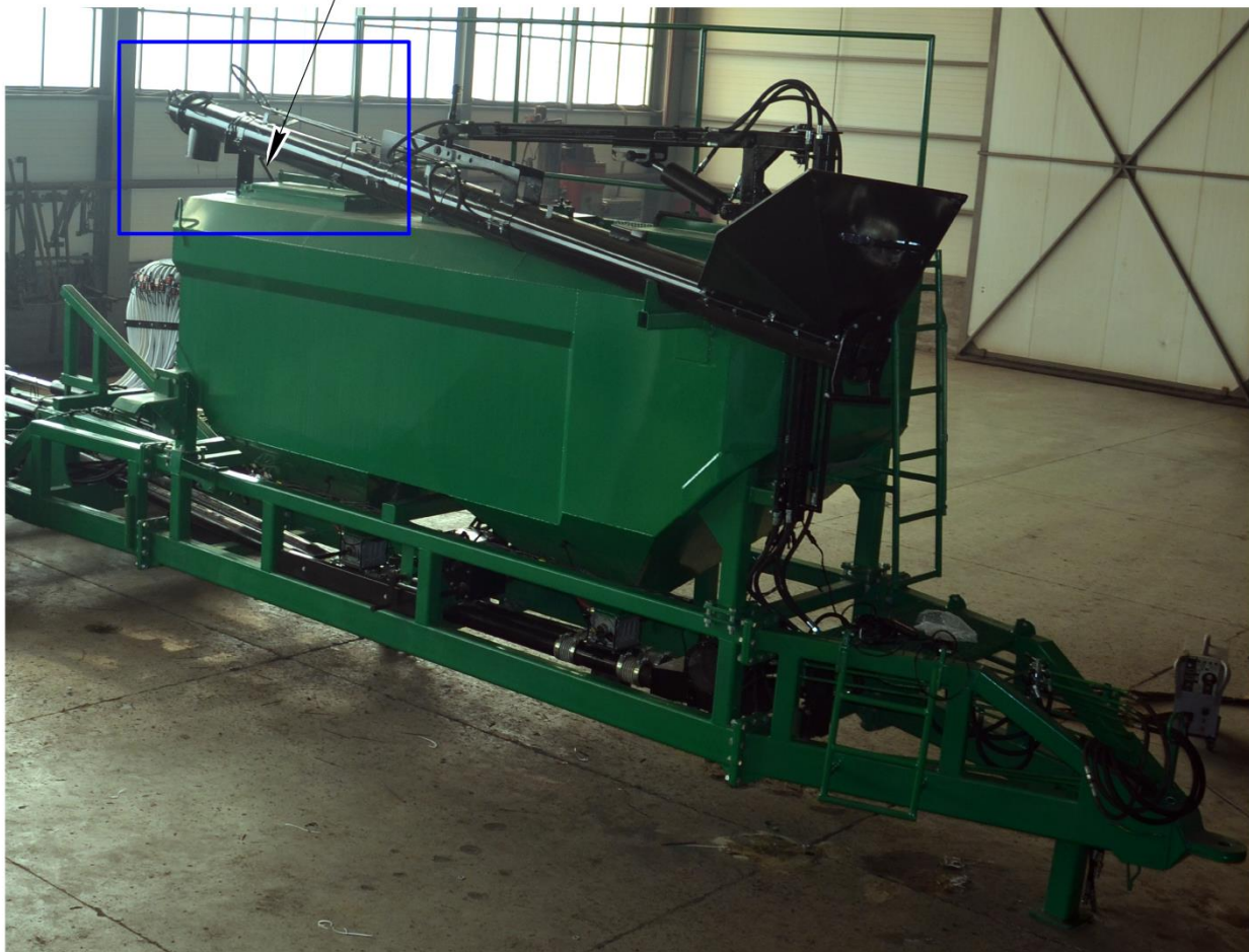
Фиксация транспортного положения шнека.
