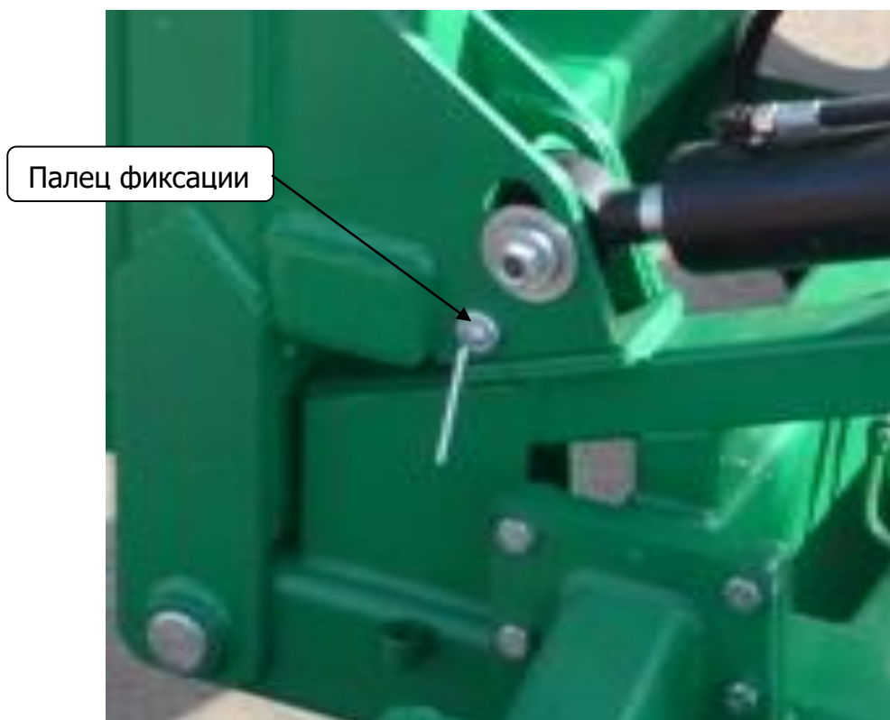
Фиксация транспортного положения крыльев.
