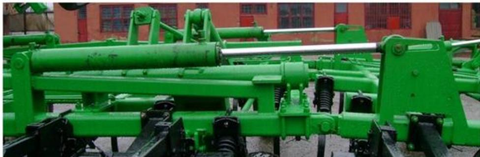
ЦГ 100x800 цилиндр подъёма крыльев.
