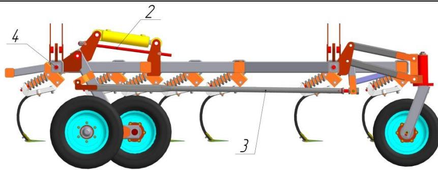
На крыльях с помощью упорных винтов (под номером 4) выставляется провисание крыльев (рекомендуется не более 2-3 см. относительно рамы), а с помощью боковых опорных колес крыльев корректируется глубина и параллельность лап относительно поверхности.
