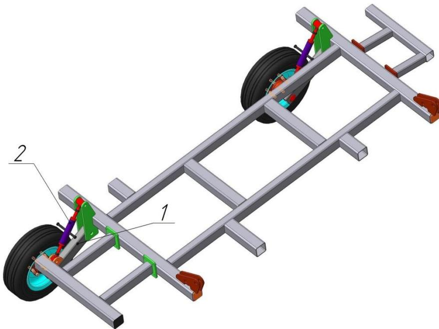
На крайних крыльях ставим стойку с колесом 1 и ставим регулировочный винт 2 для регулировки глубины обработки на крайних крыльях.
