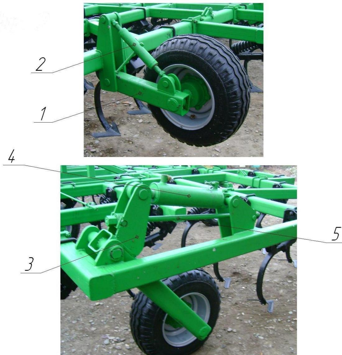
На крайних крыльях ставим стойку с колесом 1 и ставим регулировочный винт 2 для регулировки глубины обработки на крайних крыльях. Далее ставим гидрофицированный ход 3, устанавливаем на него гидроцилиндр 4 и тягу регулировки глубины обработки 5.
