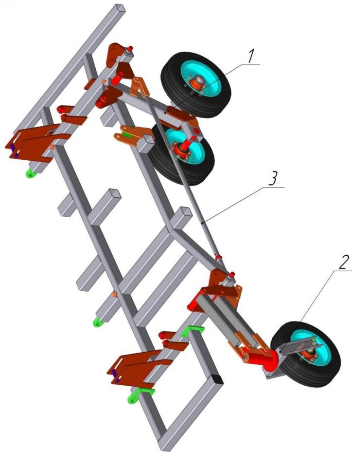
На среднем крыле колеса устанавливаем также как и на раме сначала задний балансир 1 крепим к раме крыла потом ставим переднее колесо 2 и соединяем их регулируемой тягой 3.
