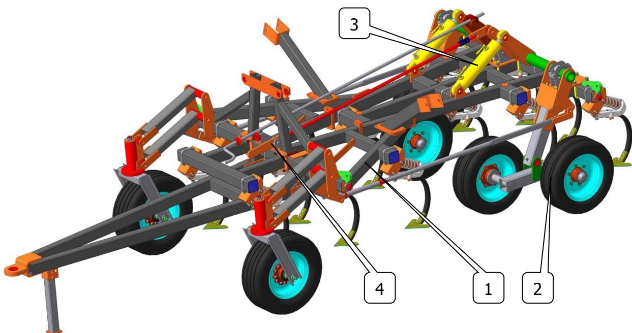
**Соединение рамы и колесного хода КРГ-6,0М.**
