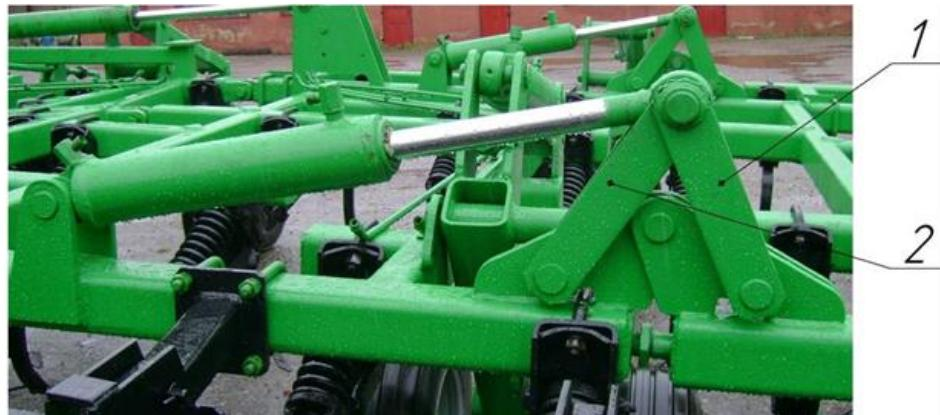
ЦГ 100x400 цилиндр подъёма крайних крыльев.
