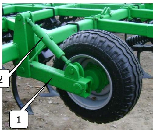
**Монтаж колесного хода на крайних крыльях КРГ-6,0М.**
