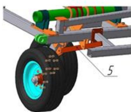
Фиксируем колесный ход тягой транспортного положения 5, потом ставим тягу регулирования глубины обработки 6.
