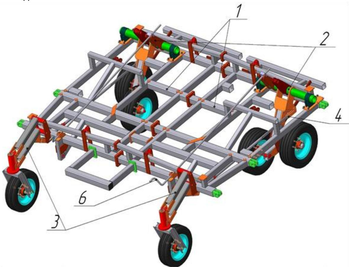
Установить колесный ход 2 и передние колеса 3 и соединить их регулируемой тягой 4.
