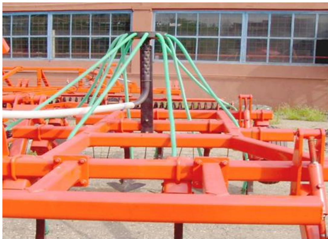
Установка распределителя на крыле.
