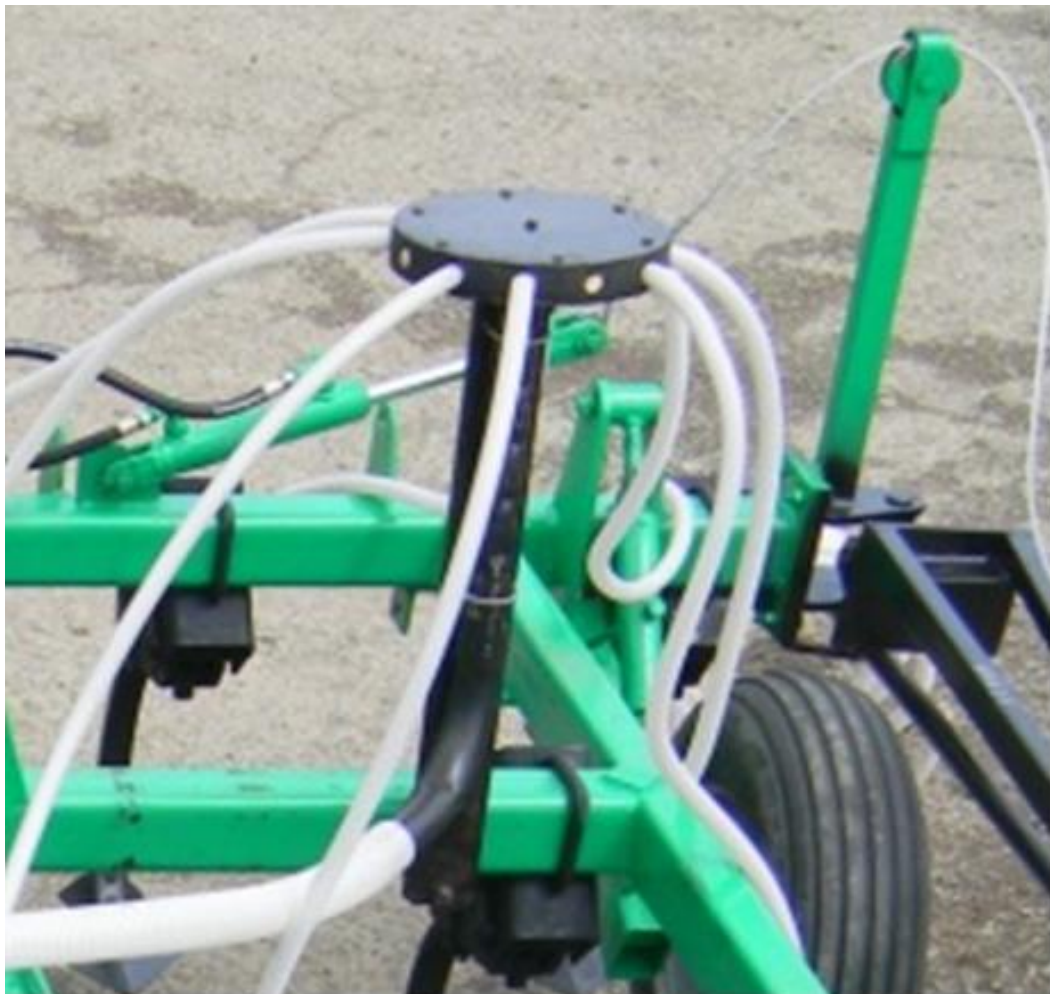
Установка распределителя на крыле.
