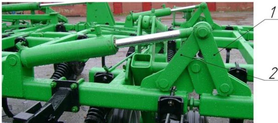
ЦГ 100x400 цилиндр подъёма крайних крыльев. 1) Тяга L=425мм 2) Тяга L=395мм.
