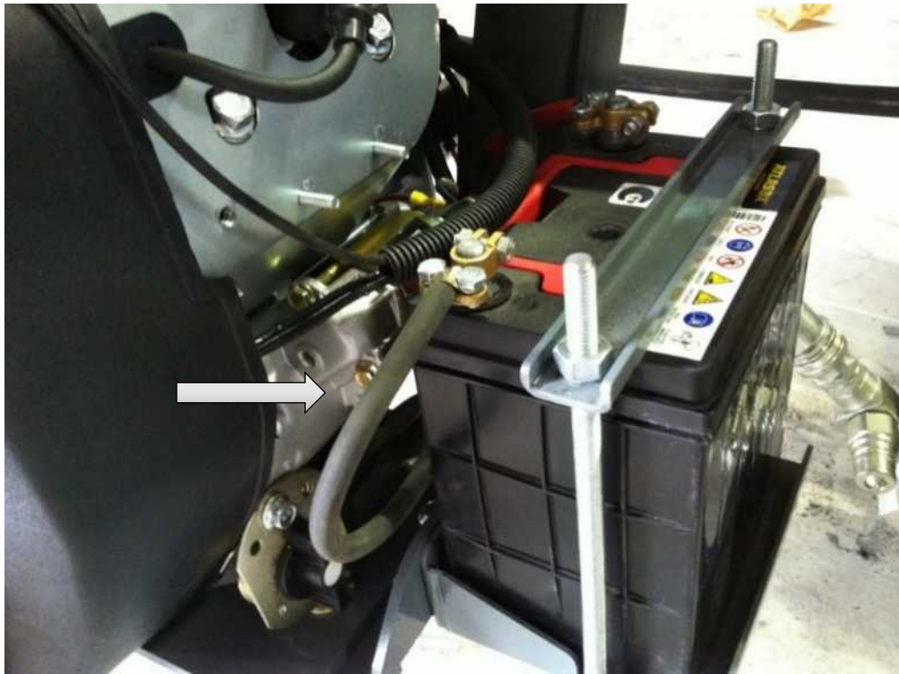
Рисунок 7.3 – АКБ и выключатель массы
