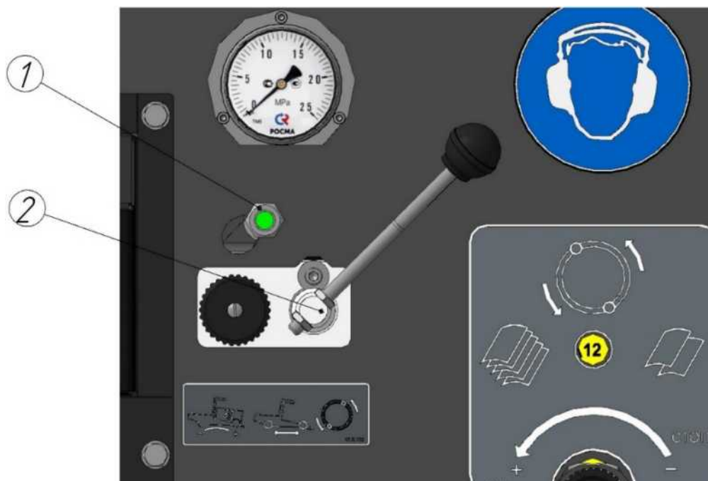
Рисунок 8.5 - Датчик положения рычага управления
