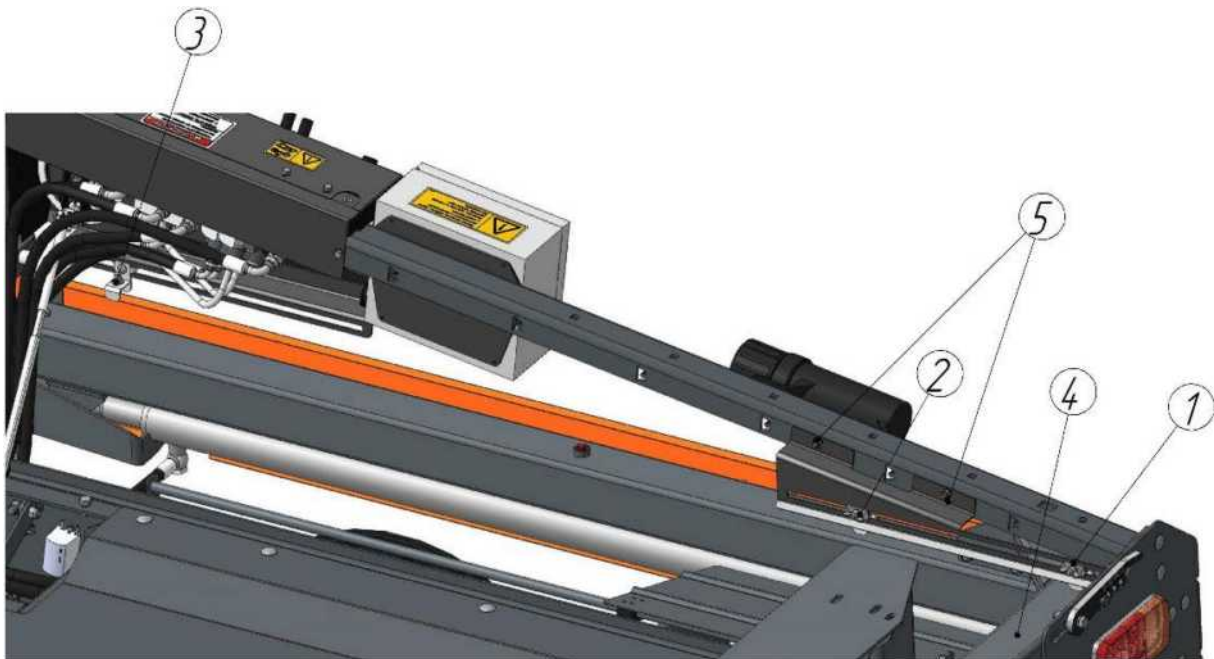
Рисунок 8.1 – Датчики положения толкателя
