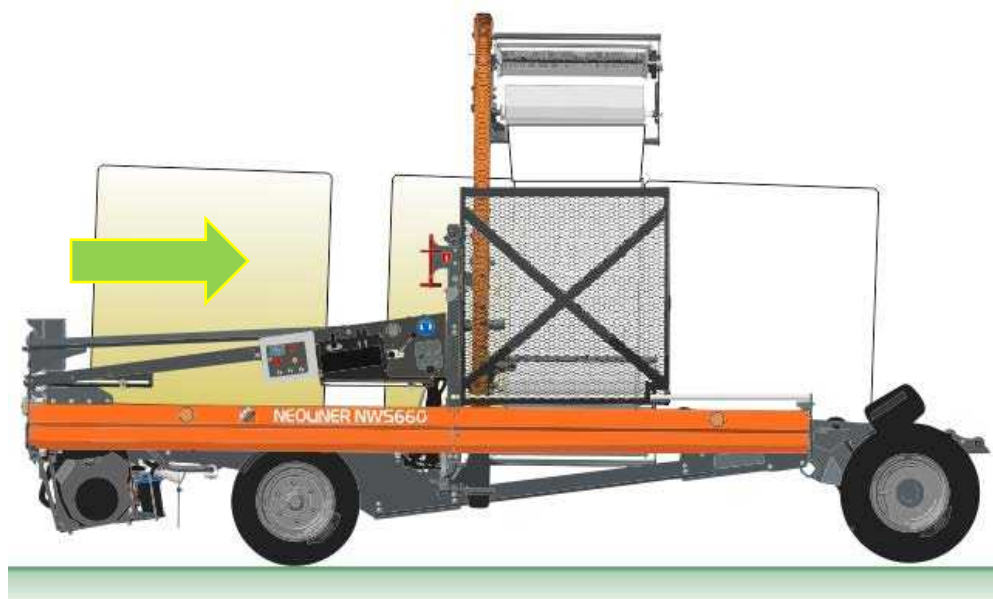
Рисунок 9.10 - Загрузка третьего рулона
