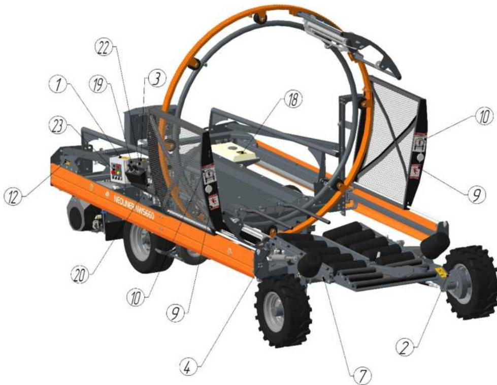
Рисунок 4.1 – Схема нанесения информационных табличек справа
