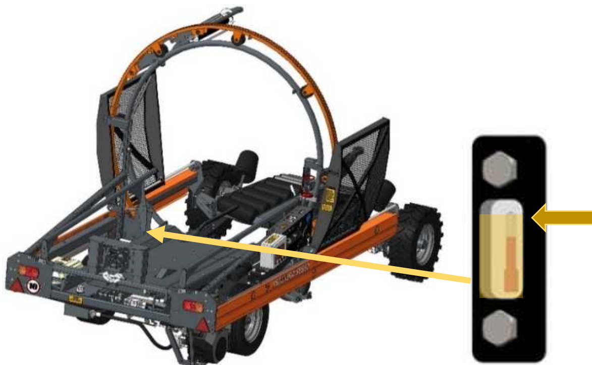
Рисунок 7.2 - Уровень гидравлической жидкости в баке
