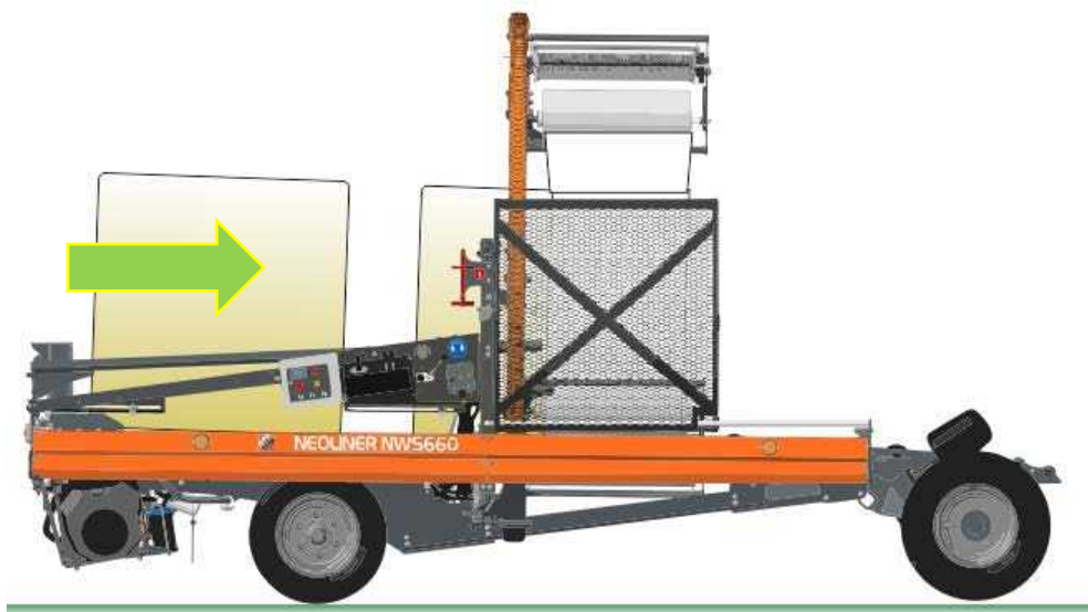
Рисунок 9.8 - Загрузка второго рулона
