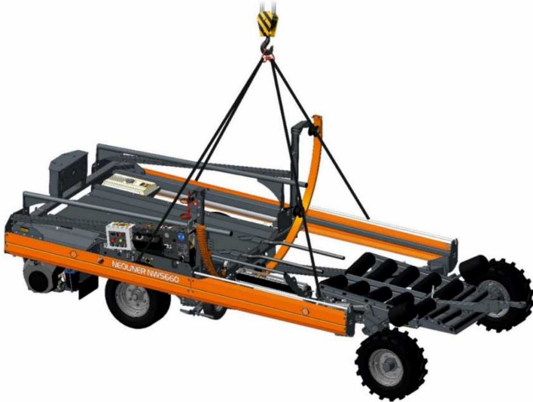
Рисунок 10.3 - Схема строповки упаковщика
