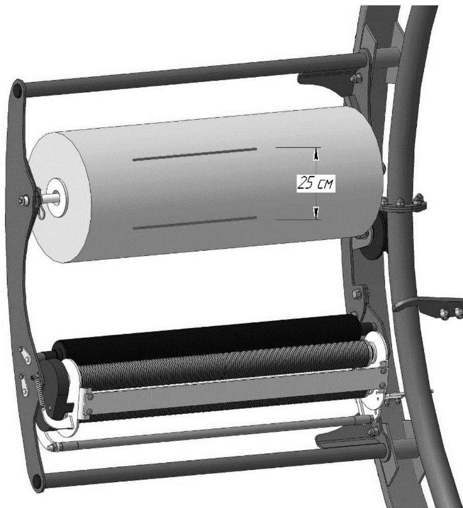
Рисунок 9.14 - Контроль растяжения плёнки
