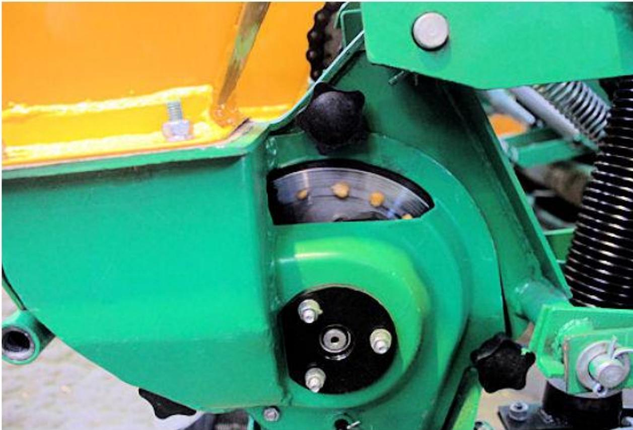
**Основой точности высева сеялок является оригинальный высевающий аппарат штампо-сварной конструкции.**
