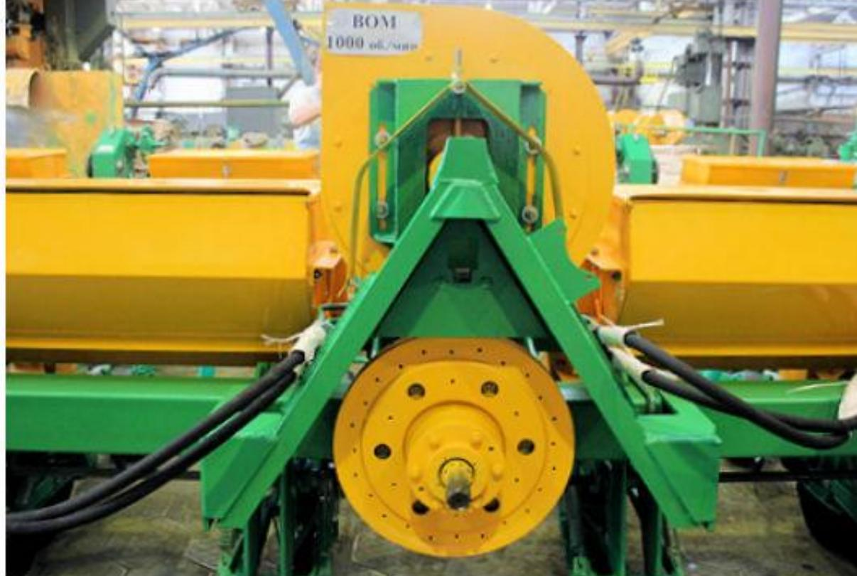
**Центробежный вентилятор оборудован обгонной муфтой, предохраняющей ременную передачу от повышенного износа.**
